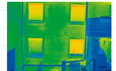
Die Hausrückseite mit alten Fenster – die gelben Flächen zeigen den Wärmeverlust.
