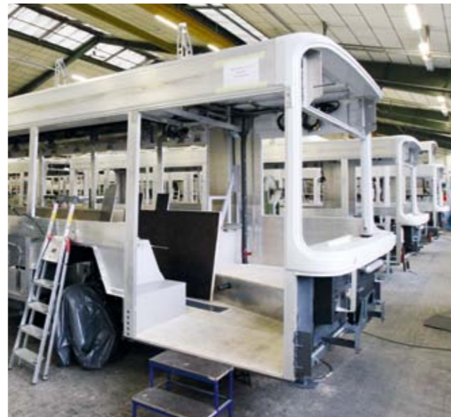
Der neue Wuppertaler Hybridbus im „Rohbau“.
